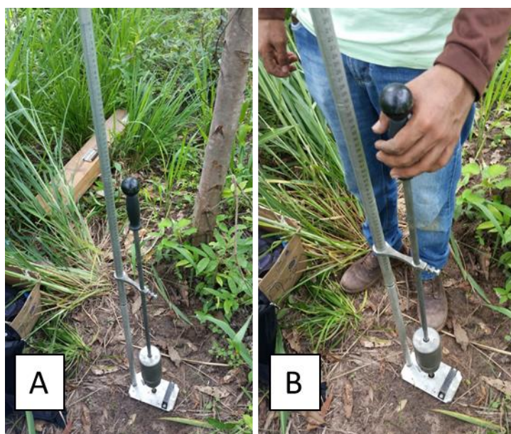
Figura 6. Posicionamento do penetrômetro de impacto na superfície do solo (A). Determinação da resistência mecânica do solo à penetração com um penetrômetro de impacto (B).
